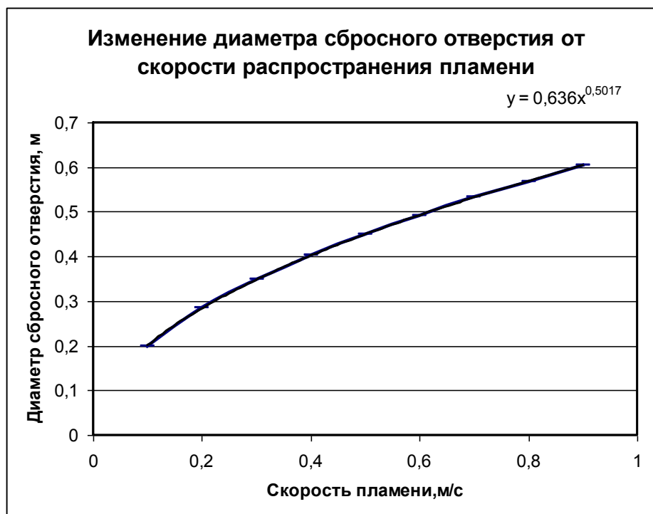
Рис. 5 Зависимость изменения диаметра сбросного отверстия взрывного клапана от скорости распространения пламени паров ацетона в цилиндрическом сосуде диаметром D = 1,8 м и высотой H = 4 м
