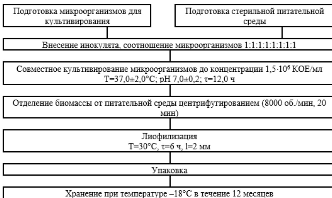
Рис. 1 Общая технологическая схема получения консорциума пробиотических микроорганизмов
