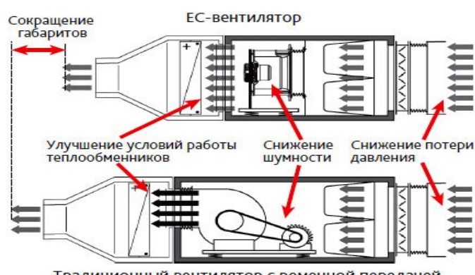
Рис. 2 Преимущества ЕС-вентилятора
