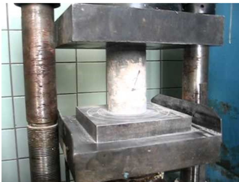
Рис. 1 Испытание образцов бетона в лабораториях
