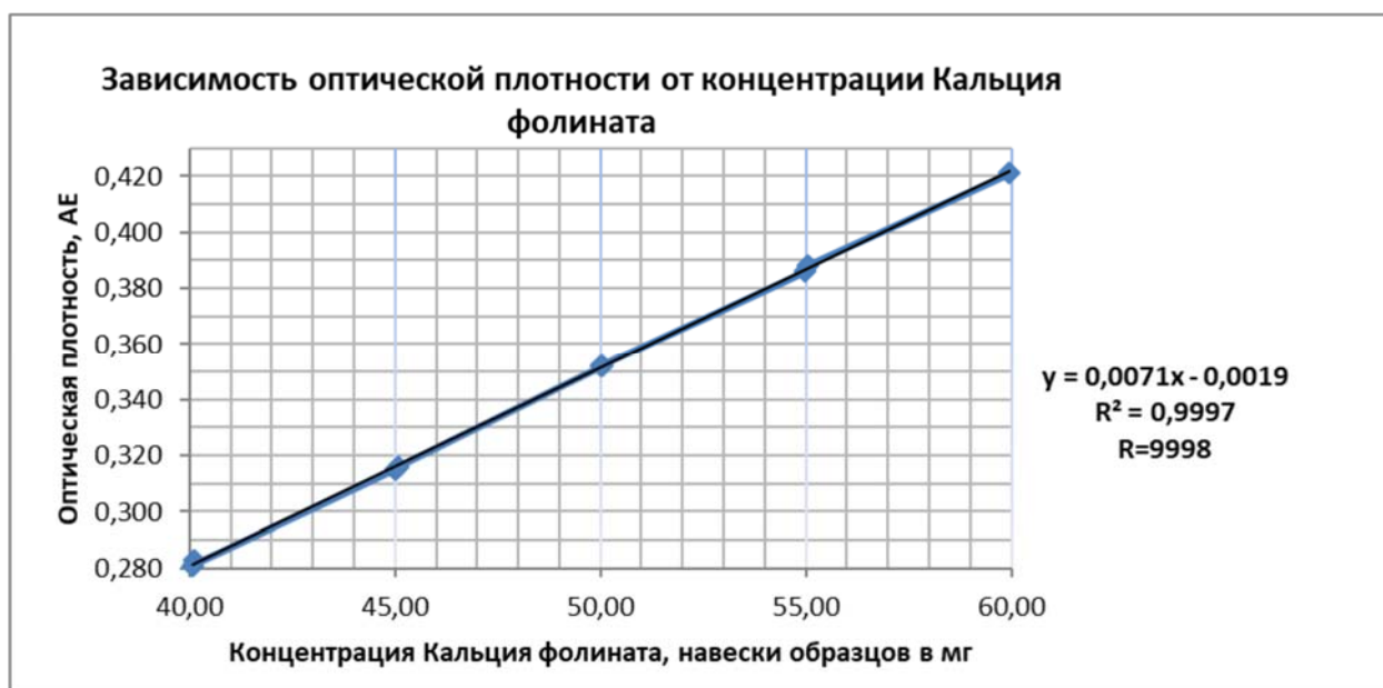
Рис. 1 Диаграмма зависимости оптической плотности от концентрации кальция фолината в растворе
