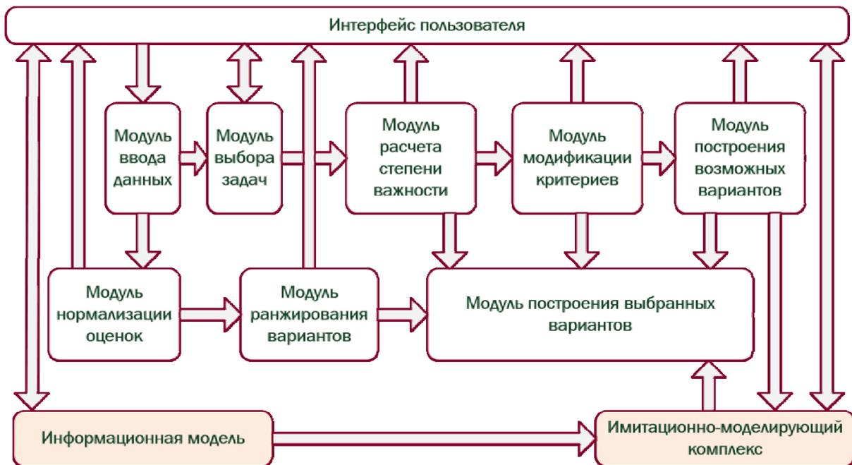
Рис. 2 Структурная схема системы поддержки принятия решения на основе моделирования
