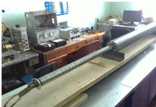
Рис. 1 Цилиндрический линейный вентильный двигатель
