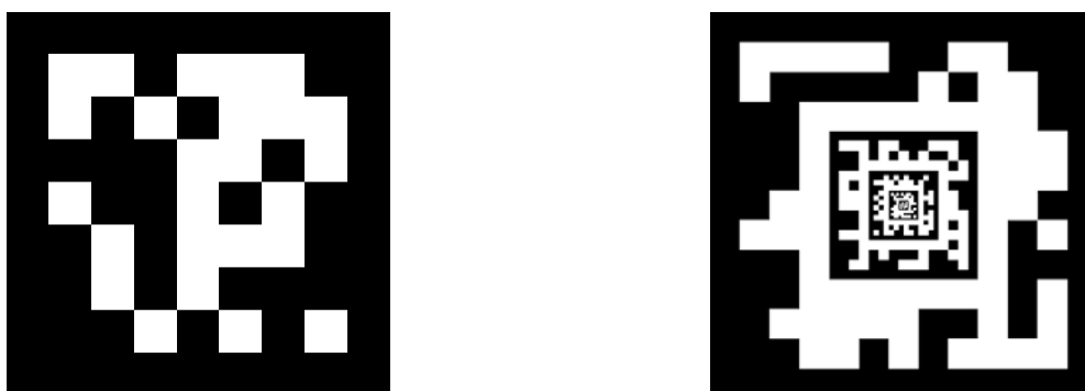
Рис. 1. Примеры маркеров, применяемых для определения положения камеры: а – фидуциальный маркер, б – фрактальный маркер
