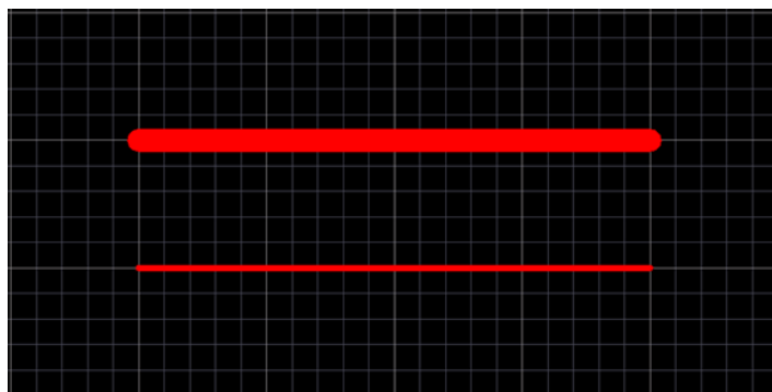
Рис. 4 Разница между стандартной шириной дорожки на печатных платах в 0,254 мм и согласованной 50-омной трассой для частоты в 10 ГГц
