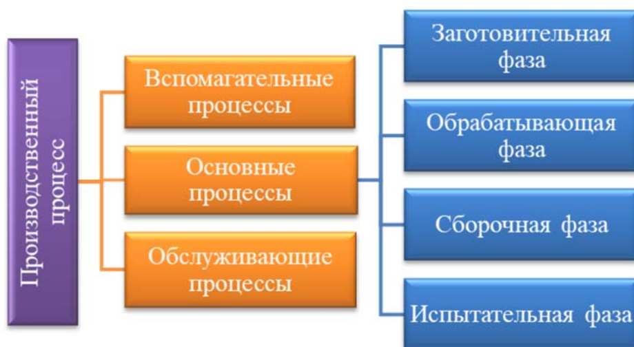
Рис. 2 Структура производственного процесса
