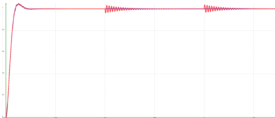
Рис. 7 Работа системы с нагрузкой, со сбитыми настройками и с корректировкой Как показывают графики, использование наблюдателя состояния позволяет
