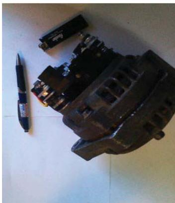
Рис.1 Опытная модель генератора с независимым включением фаз
