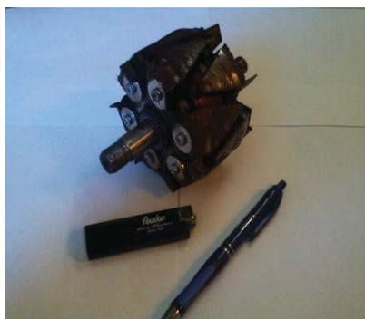
Рис.2 Ротор синхронного генератора с модернизированной магнитной системой
